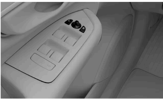
Controles para ajuste dos espelhos retrovisores laterais
