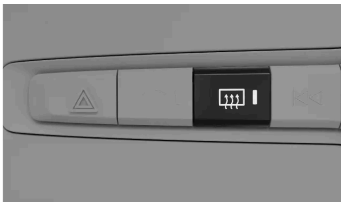
Botão de descongelar traseiro no painel de botão abaixo do visor central
