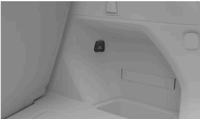
A tomada elétrica de 12 V no lado direito do porta-malas
