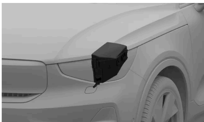
Emplacement du boîtier à fusibles
