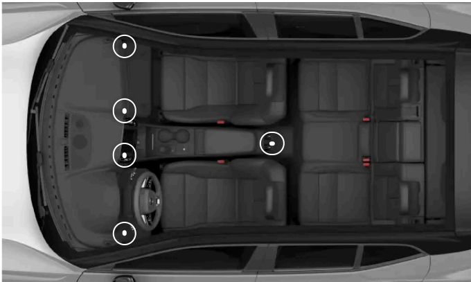
Emplacements des bouches d'air réglables
