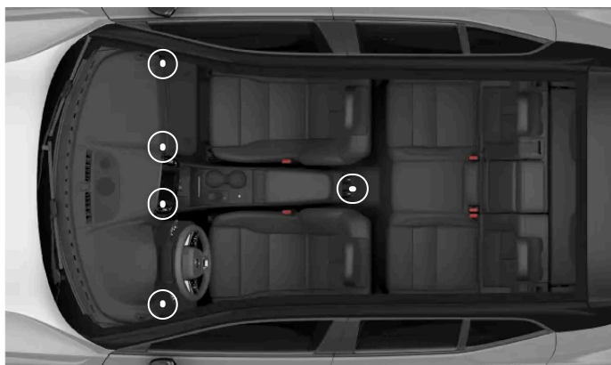
Emplacements des bouches d'air réglables
