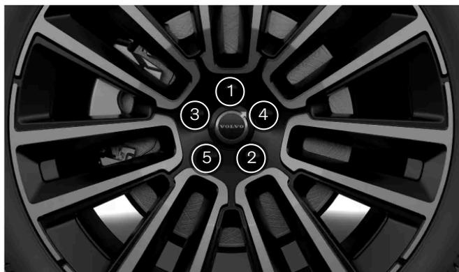
Serrez les boulons de roue en diagonale.
