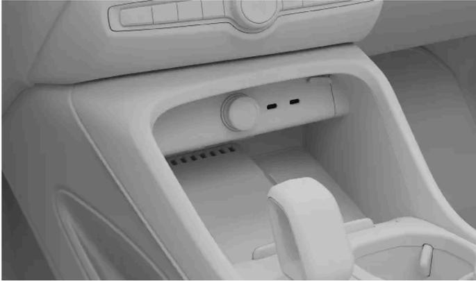
Elle comprend également deux ports USB (type C) dans la partie arrière de la console centrale.
