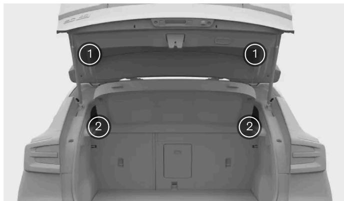
La plage arrière et le hayon sont dotés chacun de deux points de fixation. Lorsque la plage arrière est fixée, des cordons passent entre ses points de fixation et le hayon.
