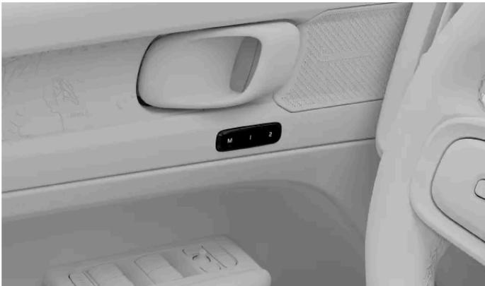
Emplacement des boutons de réglage des sièges pré-réglés
