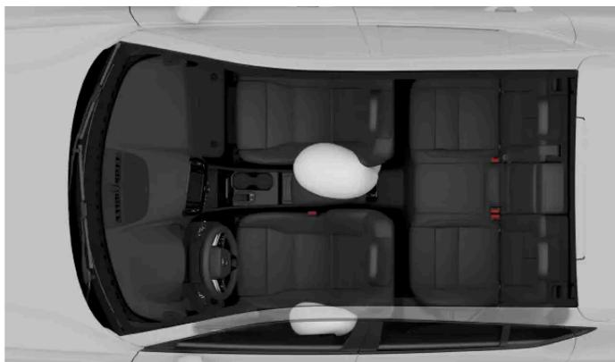
Coussins gonflables latéraux gauches pour les occupants avant. En cas de collision du côté droit, ils se déploient de l'autre côté de chaque siège avant, en position inversée par rapport au scénario représenté.
