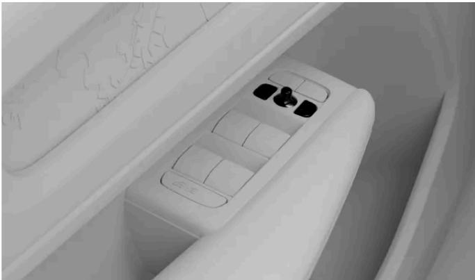
Commandes de réglage des rétroviseurs extérieurs
