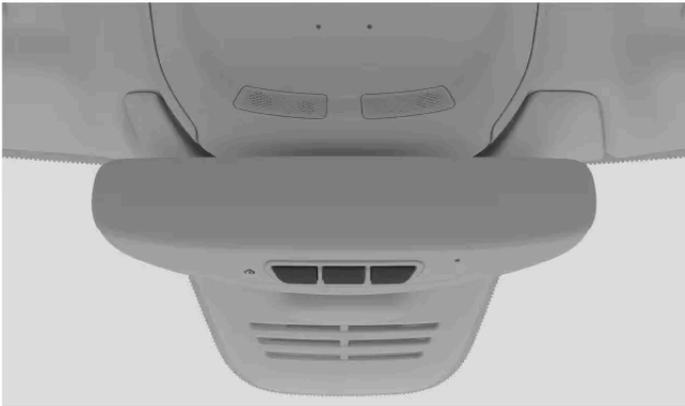
HomeLink est intégré au rétroviseur intérieur et se compose de trois boutons et d'un témoin. Vous pouvez connecter un appareil par bouton. Il est possible d'ajouter, de modifier ou de supprimer une connexion à un appareil.
