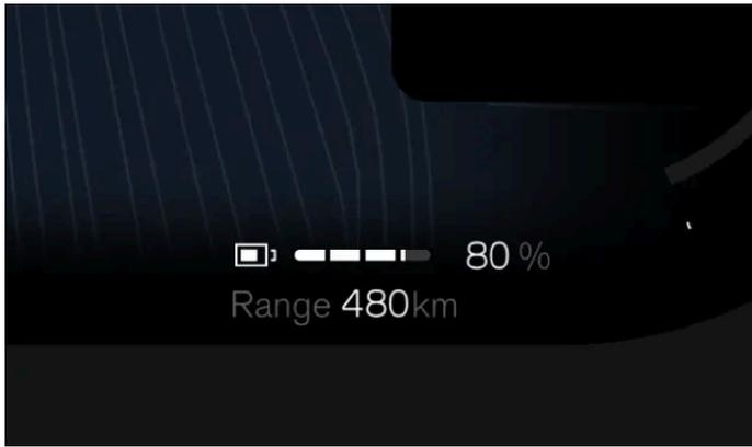
L'autonomie dépend principalement du niveau de batterie de la voiture et de vos habitudes de conduite, mais les conditions extérieures peuvent également jouer un rôle. Le niveau de batterie et l'autonomie prévue sont affichés dans l'écran du conducteur. L'autonomie prévue est calculée en fonction de vos habitudes de conduite actuelles et passées.
