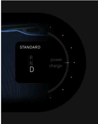
Le mode de conduite sélectionné est indiqué au-dessus du rapport sélectionné dans l'écran du conducteur.
