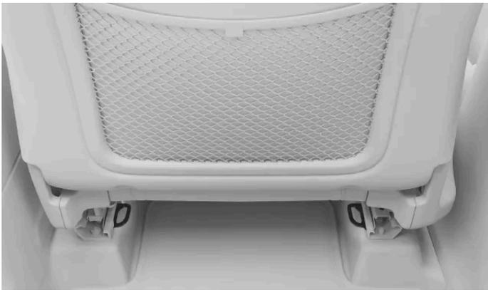
Les points d'ancrage inférieurs se trouvent à l'arrière des rails de plancher des sièges avant.
