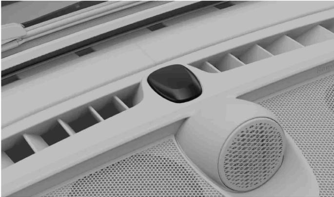
L'indicateur d'alarme est un témoin situé au centre du tableau de bord, juste devant le pare-brise. Le témoin confirme quand l'alarme est activée avec un voyant clignotant rouge.
