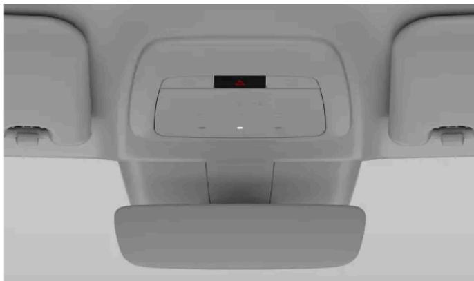
Emplacement du bouton des feux de détresse sur la console au pavillon
