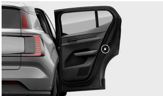
Emplacement du mécanisme de verrouillage sécurité enfant.
