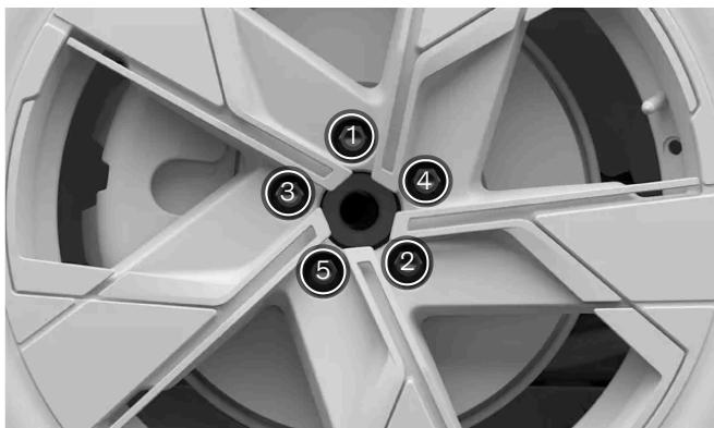
Serrez les boulons de roue en diagonale.
