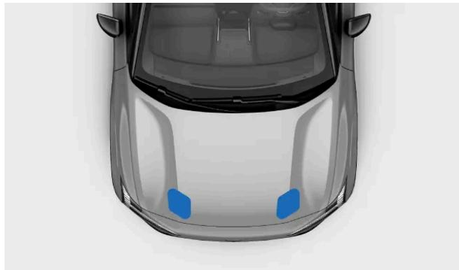
Appuyez des deux mains sur le bord avant du capot. Assurez-vous que le capot s'insère simultanément dans les serrures. Maintenez le bord avant à plat pendant la fermeture.
