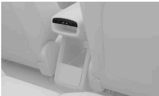
Depuis les sièges arrière, vous pouvez actionner les vitres arrière à l'aide des commutateurs situés sur l'arrière de l'accoudoir central.
