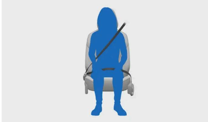
La ceinture de sécurité se bloque d'elle-même pour servir de dispositif de retenue dans certaines conditions. Il peut s'agir d'une traction soudaine et vigoureuse de la ceinture, si la voiture est conduite de manière agressive ou si elle se trouve sur une pente raide.
