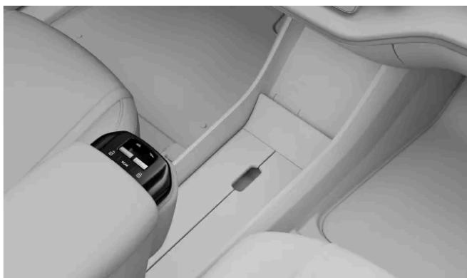
Vous pouvez commander toutes les vitres électriques depuis les sièges avant. Appuyez sur le bouton REAR pour passer de la commande des vitres avant à celle des vitres arrière. Le bouton devient orange pour indiquer que les vitres arrière sont sélectionnées. Les commandes reviennent aux vitres avant si vous appuyez à nouveau sur le bouton ou après quelques secondes d'inactivité.
