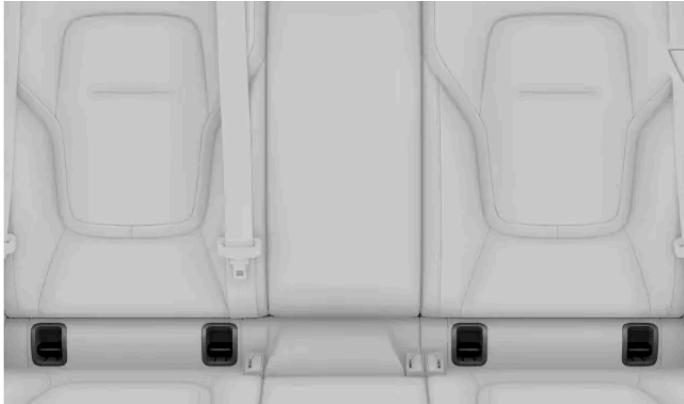
Les points d'ancrage ISOFIX<sup>[1]</sup> pour les sièges arrière sont dissimulés par un rabat dans la partie inférieure du dossier des sièges arrière latéraux. Vous devez déplier le rabat pour accéder aux points d'ancrage.
