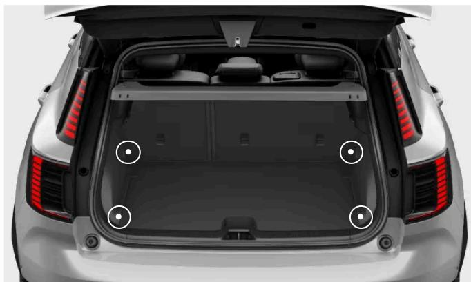
Des œillets de maintien de charge sont situés aux quatre coins du coffre. Vous pouvez utiliser les œillets de maintien de charge pour attacher des sangles et sécuriser la cargaison dans le coffre.
