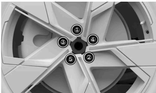
Serrez les boulons de roue en diagonale.
