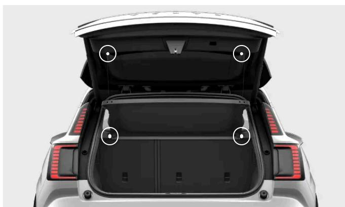
La plage arrière et le hayon sont dotés chacun de deux points de fixation. Lorsque la plage arrière est fixée, des cordons passent entre ses points de fixation et le hayon.
