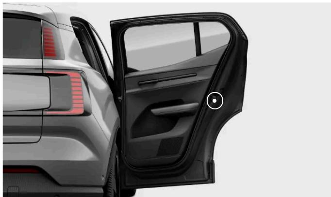
Emplacement du mécanisme de verrouillage sécurité enfant.
