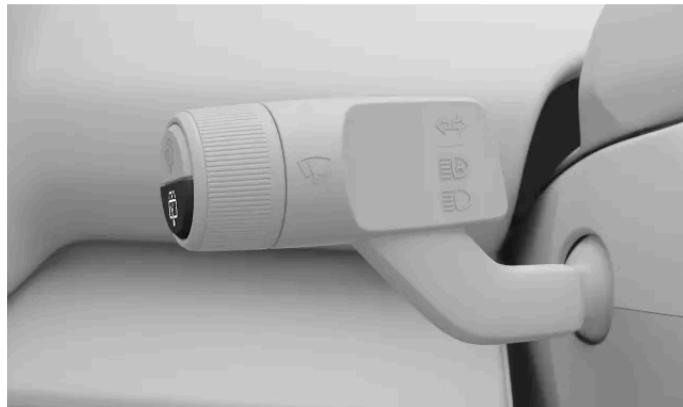
Vous commandez l'essuie-glace arrière à l'aide du bouton inférieur situé sur le levier gauche du volant.
