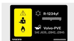
L'étiquette contenant des renseignements sur les fluides frigorigènes du système de climatisation se trouve sous le capot, sur le côté droit de la voiture.
