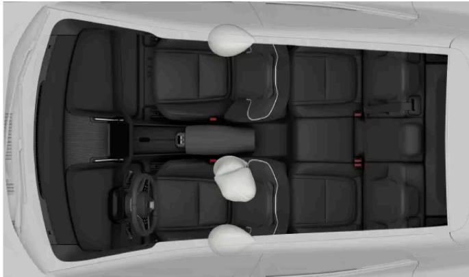
Coussins gonflables protégeant les occupants contre une collision latérale.
