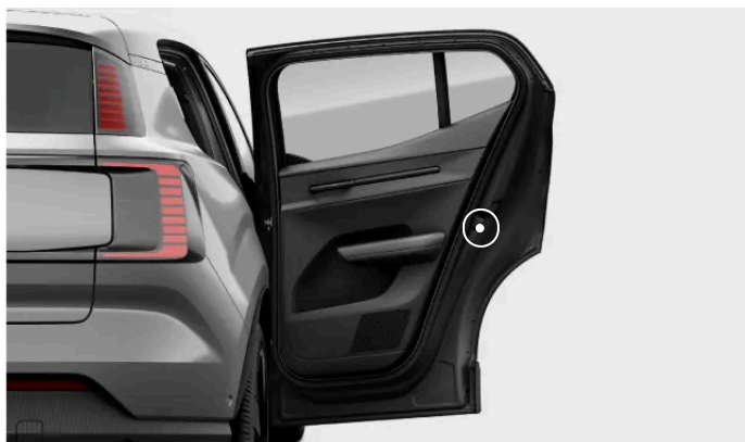
Emplacement du mécanisme de verrouillage sécurité enfant.
