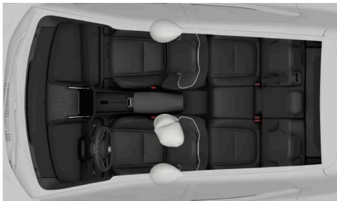
Coussins gonflables protégeant les occupants contre une collision latérale.
