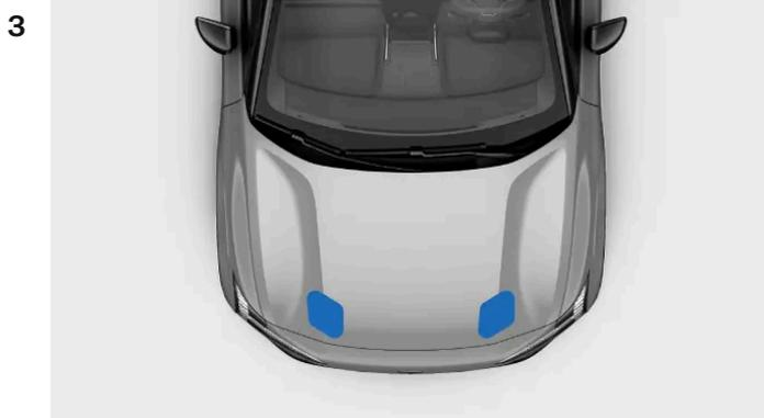
Appuyez des deux mains sur le bord avant du capot. Assurez-vous que le capot s'insère simultanément dans les serrures. Maintenez le bord avant à plat pendant la fermeture.
