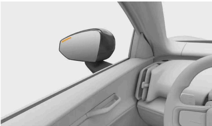
Lorsque la voiture détecte des véhicules qui s'approchent d'elle, un voyant s'allume dans le rétroviseur extérieur et une notification s'affiche à l'écran. Si vous commencez à ouvrir la porte du côté de la circulation détectée, l'alerte s'intensifie. Une alerte sonore peut accompagner les alertes visuelles en fonction de l'urgence de l'alerte.
