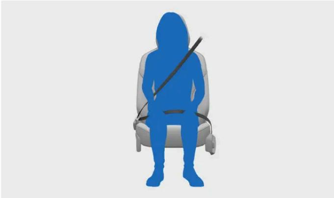
La ceinture de sécurité se bloque d'elle-même pour servir de dispositif de retenue dans certaines conditions. Il peut s'agir d'une traction soudaine et vigoureuse de la ceinture, si la voiture est conduite de manière agressive ou si elle se trouve sur une pente raide.
