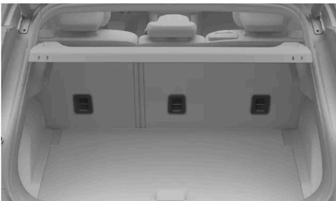
Les points d'ancrage supérieurs des sièges arrière sont situés au dos des sièges arrière.
