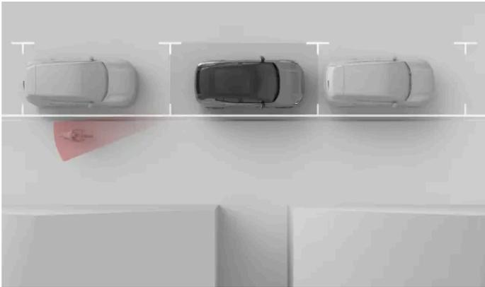
Les alertes d'ouverture de porte visent à vous avertir de la circulation afin que vous n'ouvriez pas la porte sur son passage. Ces alertes peuvent être émises lorsque la voiture est à l'arrêt ou se déplace très lentement<sup>[1]</sup>.
