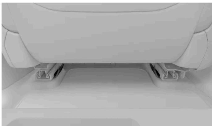
Les points d'ancrage inférieurs pour les sièges arrière se trouvent à l'arrière des longerons de châssis des sièges avant.
