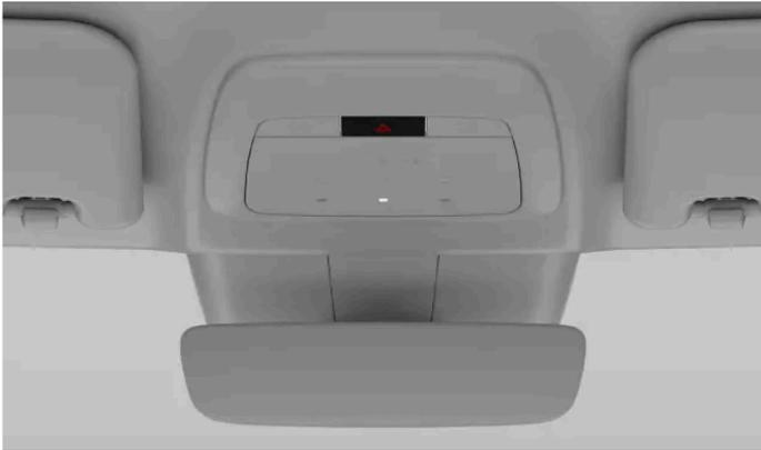
Emplacement du bouton des feux de détresse sur la console au pavillon
