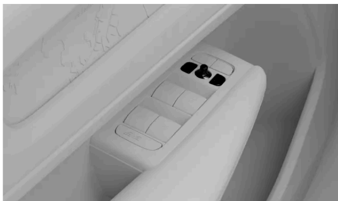
Commandes de réglage des rétroviseurs extérieurs
