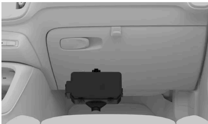
Emplacement du boîtier à fusibles
