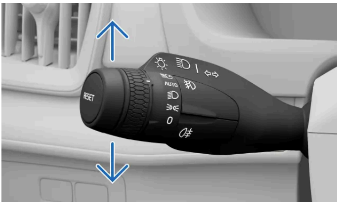
Les clignotants sur le levier gauche
