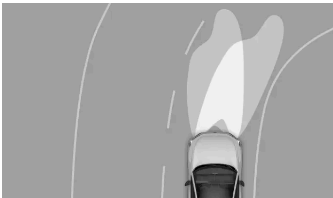
Fonction typique des phares directionnels adaptatifs
