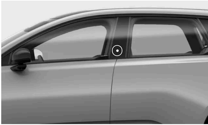
Emplacement de la lecture de clé sur le montant de porte du conducteur
