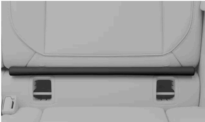
Le rabat ISOFIX replié dans l'espace situé au-dessus des points de fixation.
