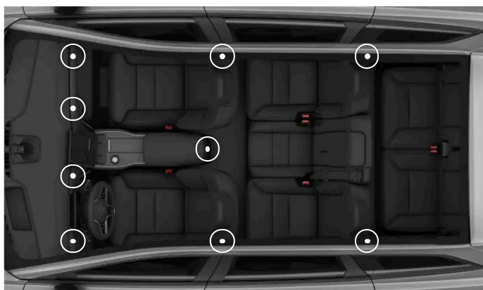
Emplacements des bouches d'air réglables
