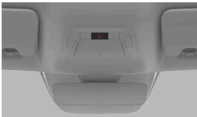
L'emplacement du bouton des feux de détresse dans la console au pavillon
