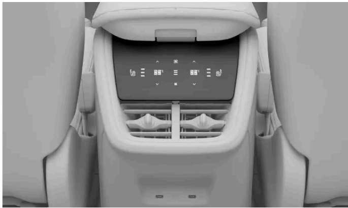
Commandes de climatisation dans la console centrale
