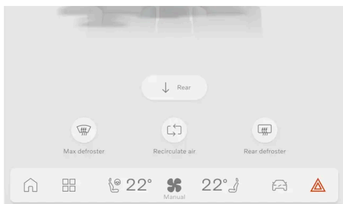
L'emplacement du bouton des feux de détresse sur l'écran central
