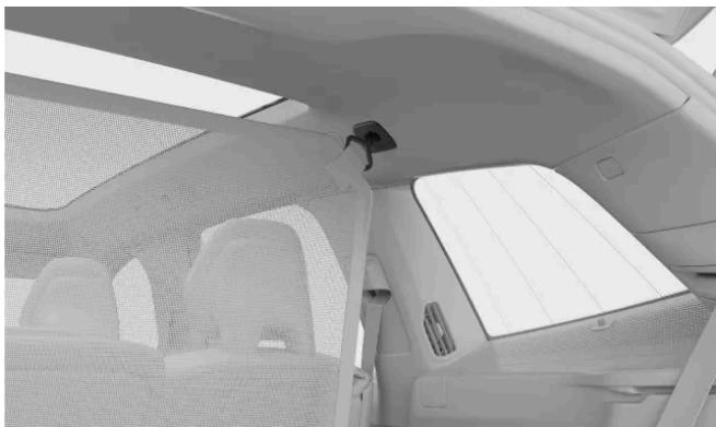
Insérez chaque tige du filet de sécurité dans les douilles situées sur les côtés du toit intérieur. Poussez les tiges vers l'avant jusqu'à ce qu'elles s'enclenchent.
