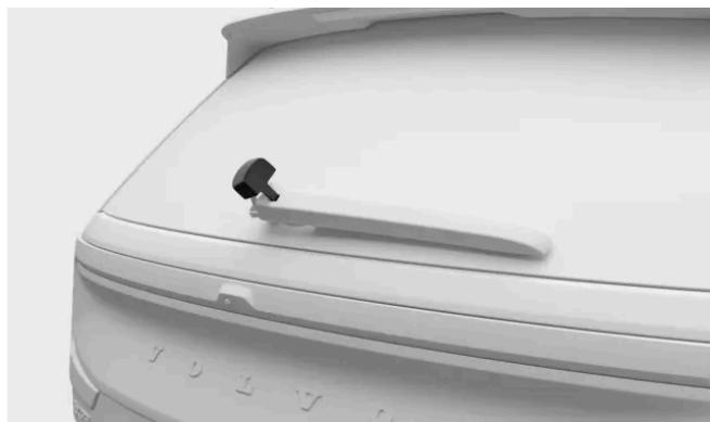
Trouvez le couvercle en plastique où le bras d'essuie-glace est fixé à la voiture. Desserrez d'abord le côté du couvercle le plus proche de vous, puis le côté le plus éloigné de vous. Soulevez complètement le couvercle en plastique. Cela vous permettra d'accéder au raccord du tuyau.
