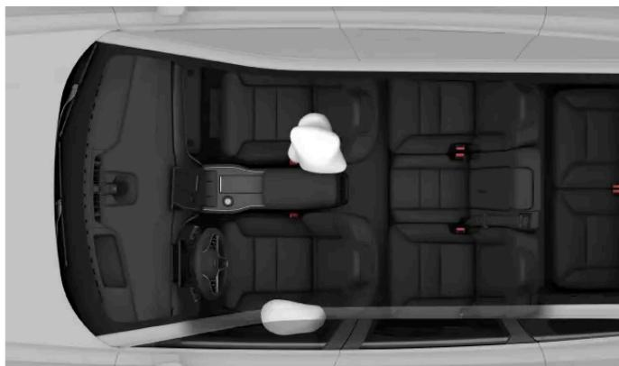
Coussins gonflables latéraux gauches pour les occupants avant. En cas de collision du côté droit, ils se déploient de l'autre côté de chaque siège avant, en position inversée par rapport au scénario représenté.
