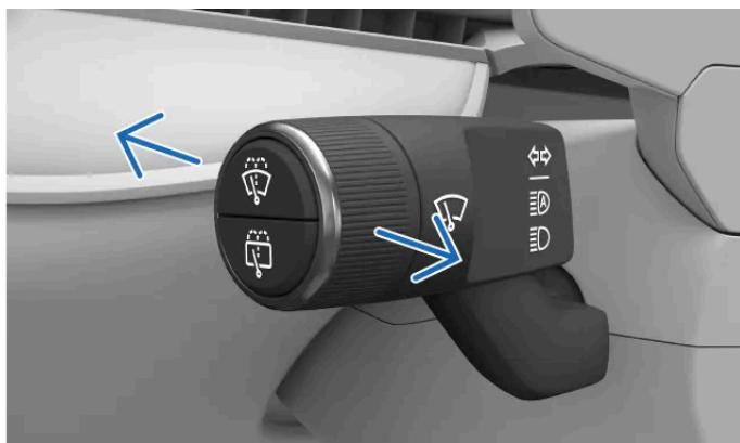
Vous pouvez déplacer le levier gauche vers l'avant ou vers l'arrière pour basculer entre différentes options de feux de route. Le levier revient toujours à la position neutre.
