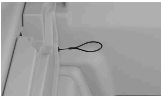
➤ Le câble de recharge se déverrouille de la prise.
