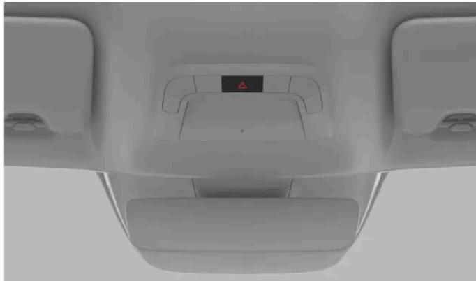
L'emplacement du bouton des feux de détresse dans la console au pavillon
