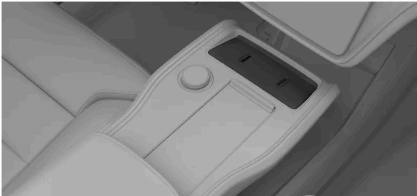
Pour utiliser un chargeur sans fil, votre appareil devrait être certifié avec la norme de recharge sans fil Qi. Assurez-vous aussi que la recharge sans fil est activée sur l'appareil<sup>[1]</sup> et le chargeur lui-même. Vous pouvez activer le chargeur dans l'écran central.
