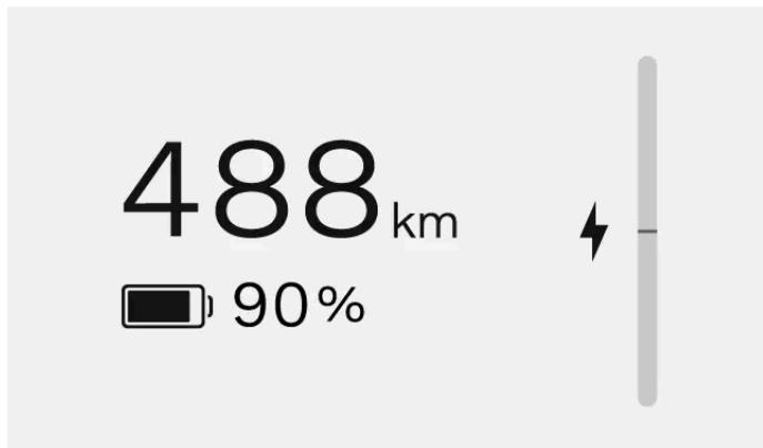
L'autonomie dépend principalement du niveau de batterie de la voiture et de vos habitudes de conduite, mais les conditions extérieures peuvent également jouer un rôle. Le niveau de batterie et l'autonomie prévue sont affichés dans l'écran du conducteur. L'autonomie prévue est calculée en fonction de vos habitudes de conduite actuelles et passées.
