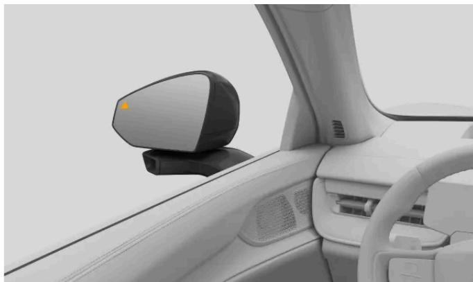
Lorsque la voiture détecte des véhicules qui s'approchent d'elle, un voyant s'allume dans le rétroviseur extérieur. Si vous commencez à ouvrir la porte du côté de la circulation détectée, l'alerte s'intensifie. Une alerte sonore peut accompagner les alertes visuelles en fonction de l'urgence de l'alerte.
