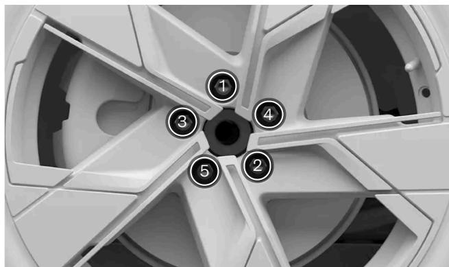
Serrez les boulons de roue en diagonale.
