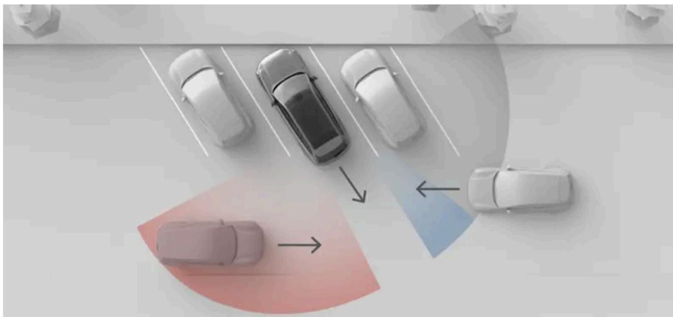
La situation illustrée dans cette image montre comment les objets environnants, tels que les voitures garées, peuvent limiter la capacité de la voiture à détecter les autres véhicules et les situations de circulation. En l'absence d'obstacles, les zones de détection actives sont les mêmes des
