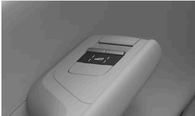
Appuyez sur le symbole de vitre pour passer du contrôle des vitres avant à celui des vitres arrière. La sélection actuelle est indiquée par les témoins à côté des symboles.
