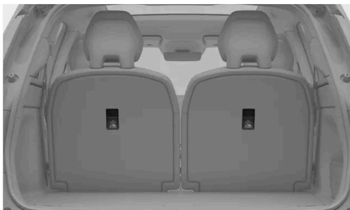
L'emplacement des points d'ancrage supérieurs pour les sièges de la deuxième rangée et de la troisième rangée est indiqué par le symbole d'ancrage supérieur.
