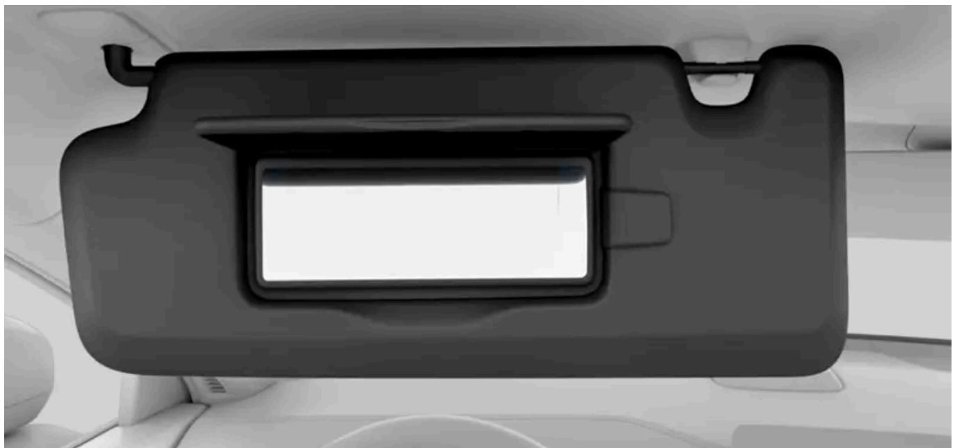
Les pare-soleil peuvent être rabattus et orientés vers le côté si nécessaire. Lorsque le pare-soleil est incliné sur le côté, vous pouvez également allonger la tige qui le maintient pour mieux le positionner.
