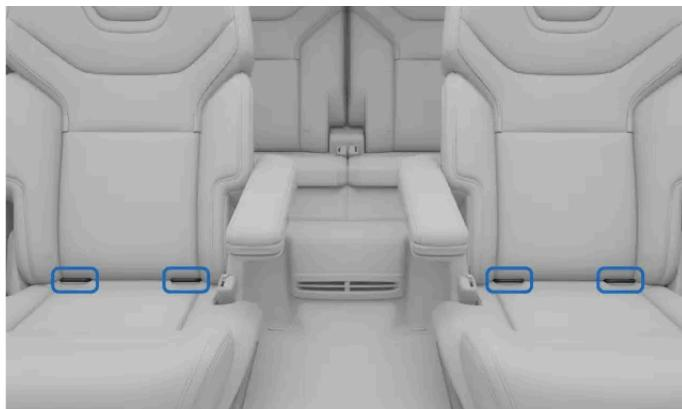
Emplacement des points d'ancrage ISOFIX<sup>[1]</sup> pour les sièges de la deuxième rangée
