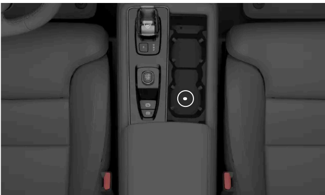
Emplacement du lecteur de secours à l'intérieur du porte-gobelet de la console centrale
