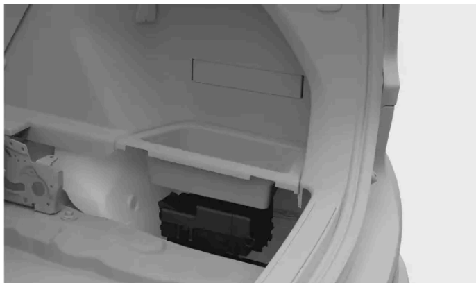
Emplacement du boîtier à fusibles
