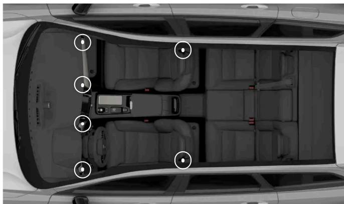
Emplacements des bouches d'air réglables
