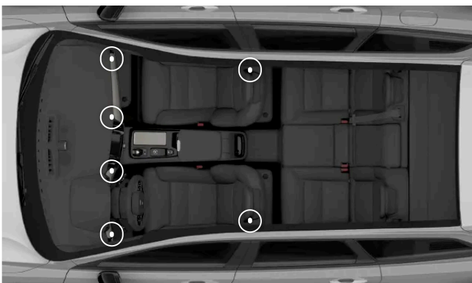
Emplacements des bouches d'air réglables
