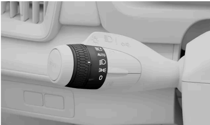
Le symbole des feux de croisement sur la bague rotative du levier gauche
