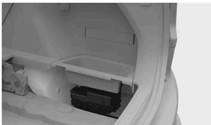
Emplacement du boîtier à fusibles
