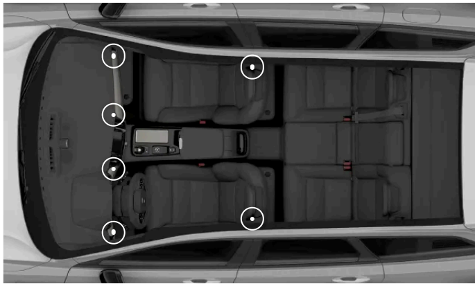
Emplacements des bouches d'air réglables
