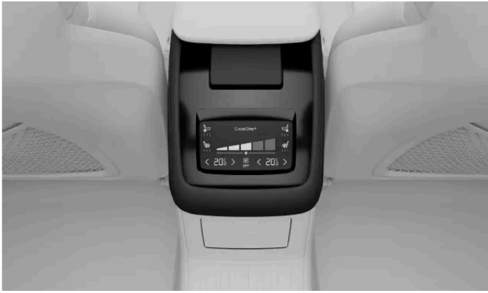
Commandes de climatisation dans la console centrale
