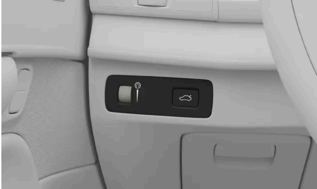
La molette de réglage de l'éclairage intérieur
