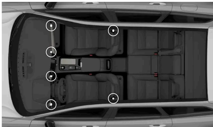
Emplacements des bouches d'air réglables
