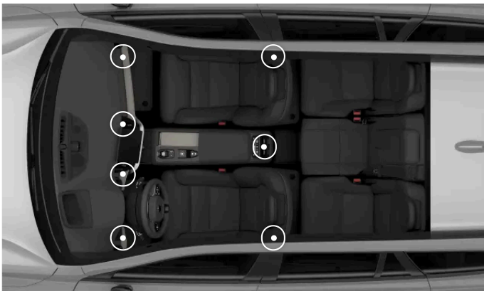
Emplacements des bouches d'air réglables
