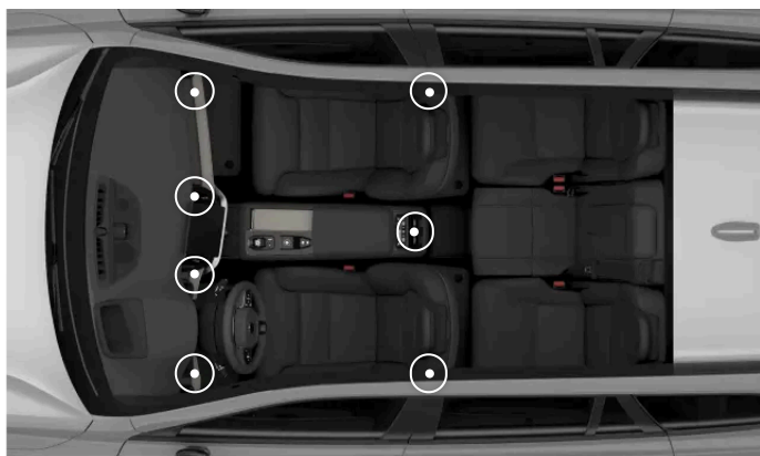
Emplacements des bouches d'air réglables
