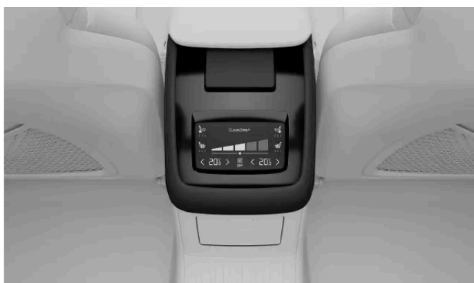
Commandes de climatisation dans la console centrale
