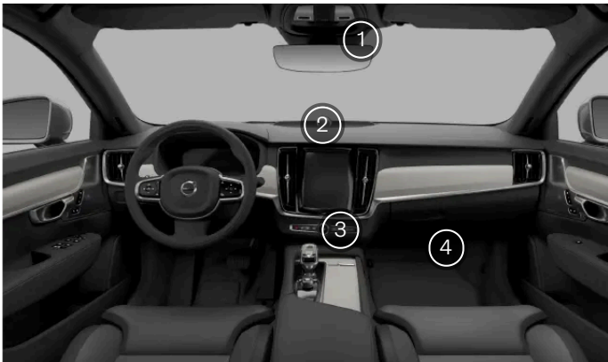
Capteurs de température de l'habitacle
