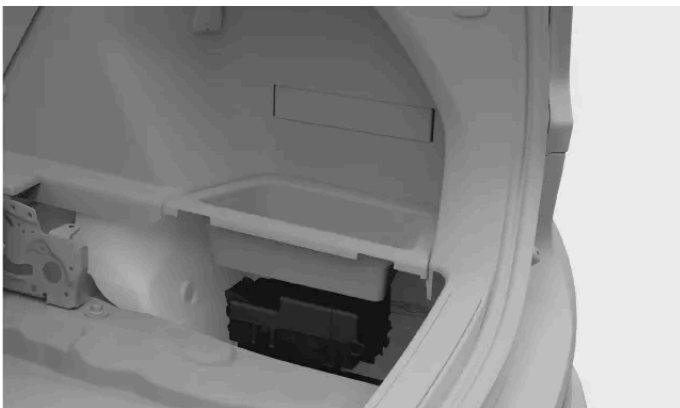
Emplacement du boîtier à fusibles
