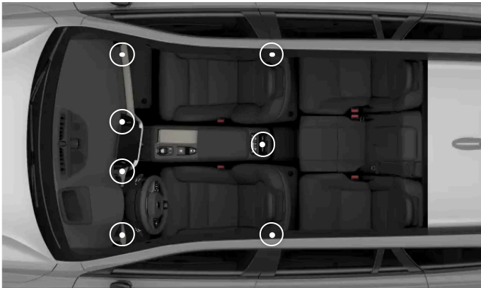
Emplacements des bouches d'air réglables
