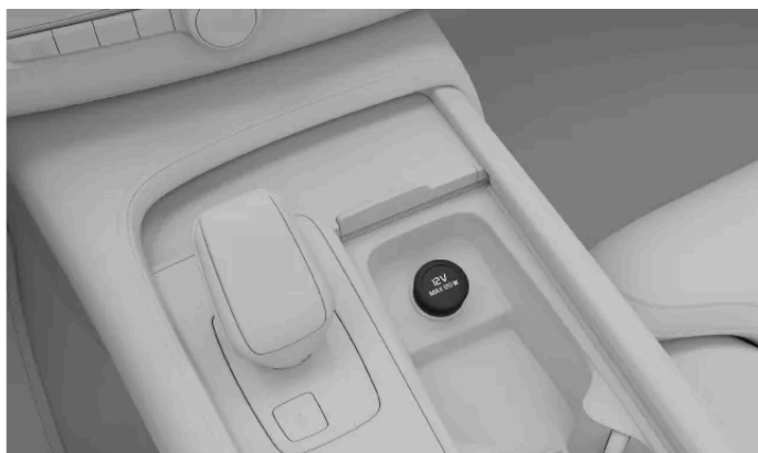
La prise 12 V dans la console centrale
