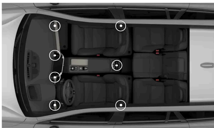
Emplacements des bouches d'air réglables
