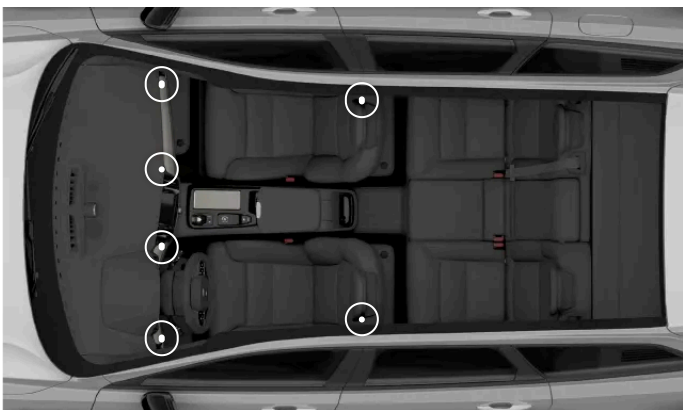
Emplacements des bouches d'air réglables
