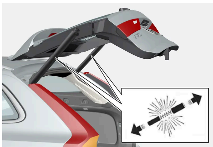
Ressorts préchargés du hayon à commande électrique.
