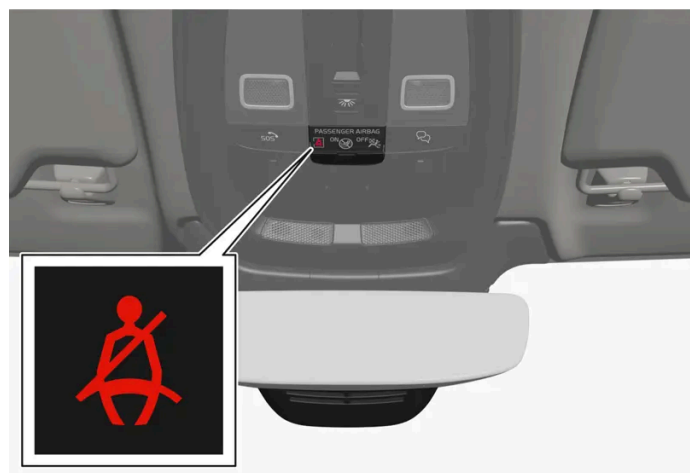
Témoin sur la console de pavillon.
