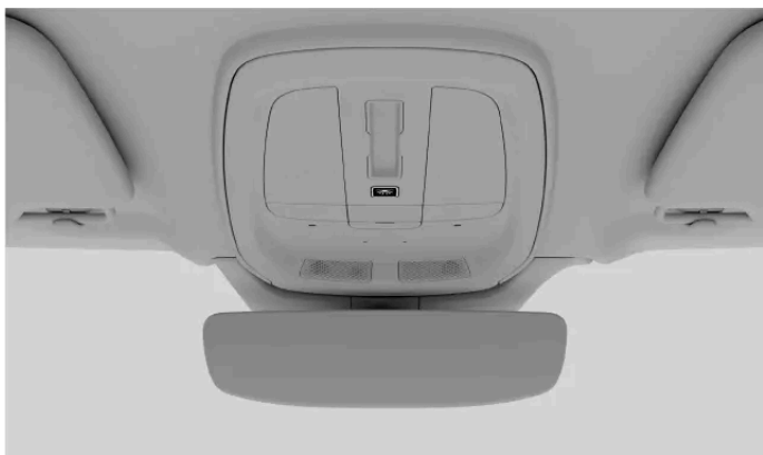
Bouton d'allumage simultané de toutes les lumières de l'habitacle situé sur la console au pavillon
