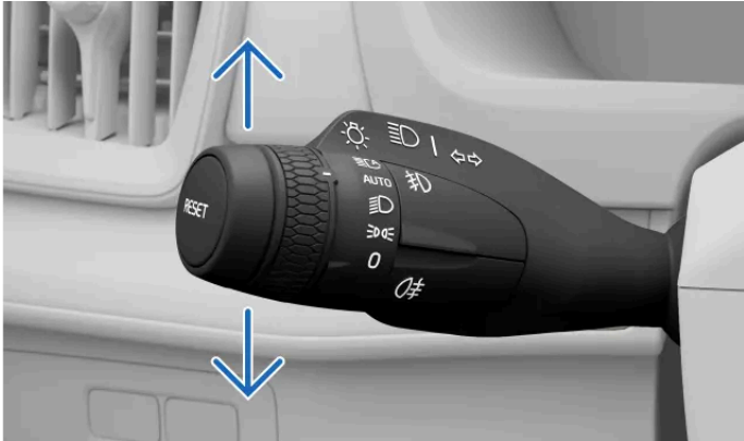
Les clignotants sur le levier gauche
