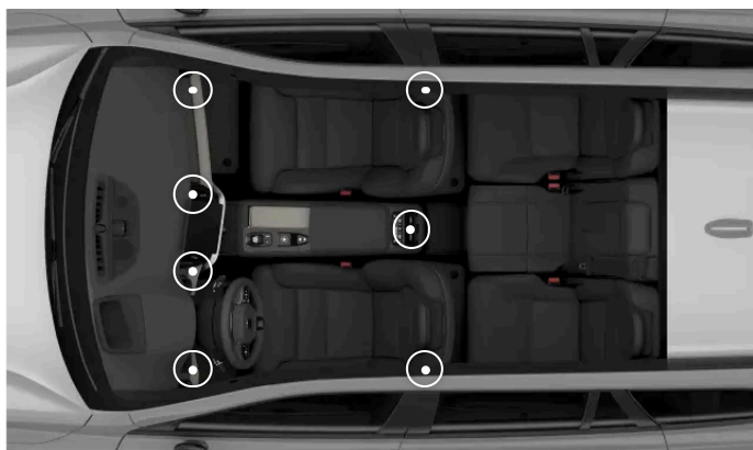
Emplacements des bouches d'air réglables
