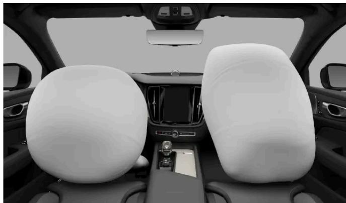
Le côté conducteur est équipé de deux coussins gonflables frontaux. Le coussin gonflable supérieur est logé à l'intérieur du volant et celui pour genoux est logé derrière un panneau sous le volant.
