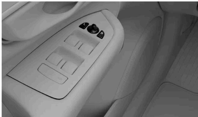
Commandes de réglage des rétrocaveirs extérieurs
