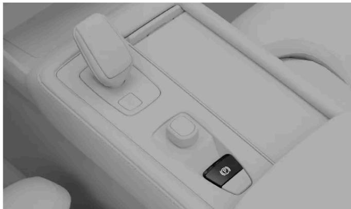
Engagez manuellement le frein de stationnement en tirant sur l'interrupteur du frein de stationnement.
