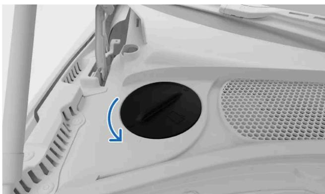
Ouvrez la trappe du panneau dans le coin supérieur gauche du compartiment moteur pour accéder au réservoir de liquide de refroidissement.
