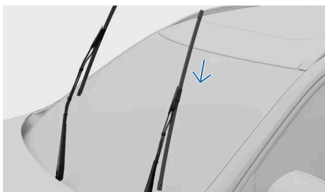
Assurez-vous que le balai du côté conducteur est plus long que celui du côté passager. Glissez le balai d'essuie-glace sur le bras d'essuie-glace. Assurez-vous que la goupille du bras d'essuie-glace s'insère dans le trou du balai d'essuie-glace. Pousser le balai dans le bras d'essuie-glace jusqu'à ce que vous entendiez un déclic.
