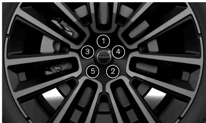
Serrez les boulons de roue en diagonale.
