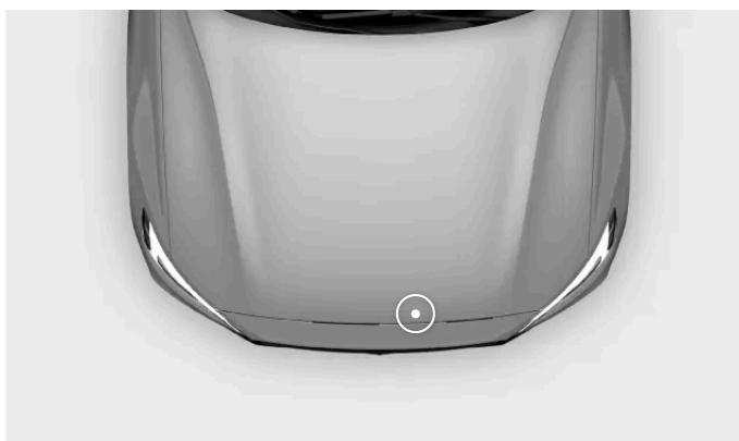
Le deuxième levier se trouve sous le bord avant du capot, côté conducteur.
