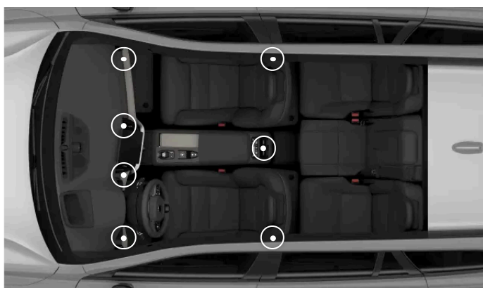
Emplacements des bouches d'air réglables
