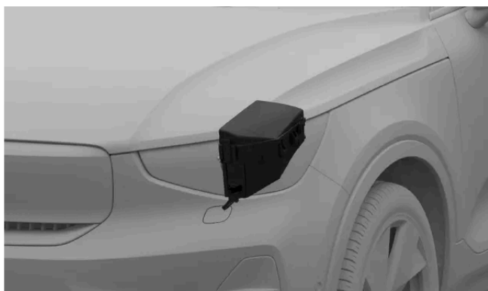
Emplacement du boîtier à fusibles
