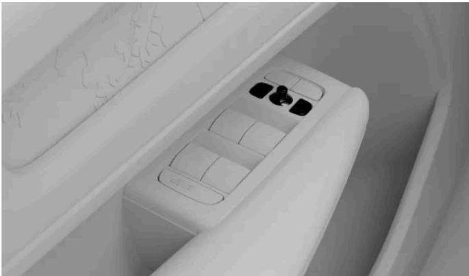
Commandes de réglage des rétroviseurs extérieurs
