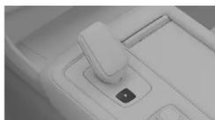
Lorsque P est sélectionné, la boîte de vitesses est bloquée mécaniquement pour éviter les changements de vitesse accidentels.
