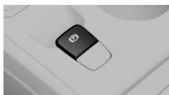
Engagez manuellement le frein de stationnement en tirant sur l'interrupteur du frein de stationnement.
