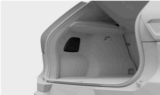
Appuyez sur le bord supérieur du panneau de recouvrement pour le faire pivoter et le retirer.
