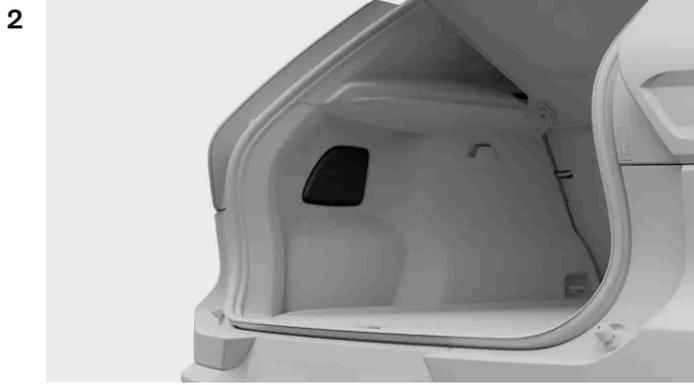
Appuyez sur le bord supérieur du panneau de recouvrement pour le faire pivoter et le retirer.
