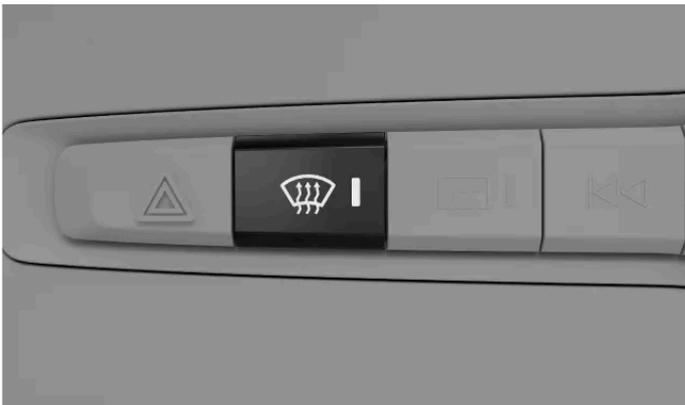
Bouton de dégivrage maximal sur le panneau de commande situé sous l'écran central
