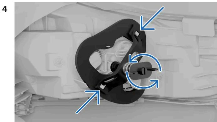
Dévisser la vis du ressort en tournant dans le sens antihoraire. Laissez la vis dans le support afin de pouvoir la retrouver en cas de besoin.
