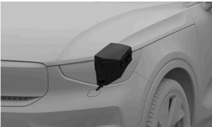
Emplacement du boîtier à fusibles
