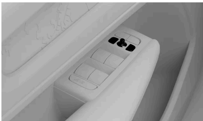
Commandes de réglage des rétroviseurs extérieurs
