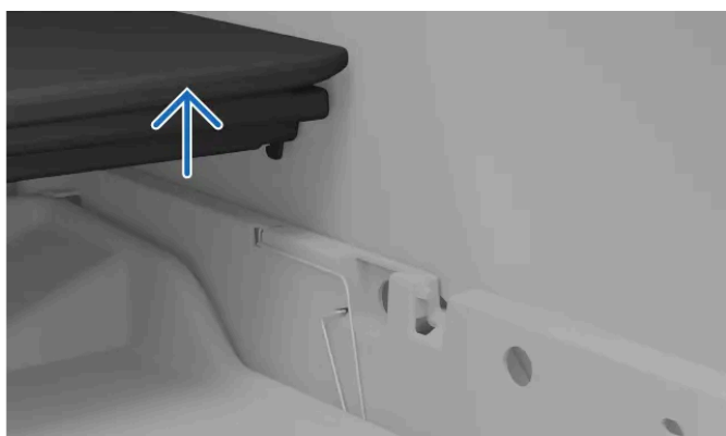
Ouverture du panneau de chargement.
