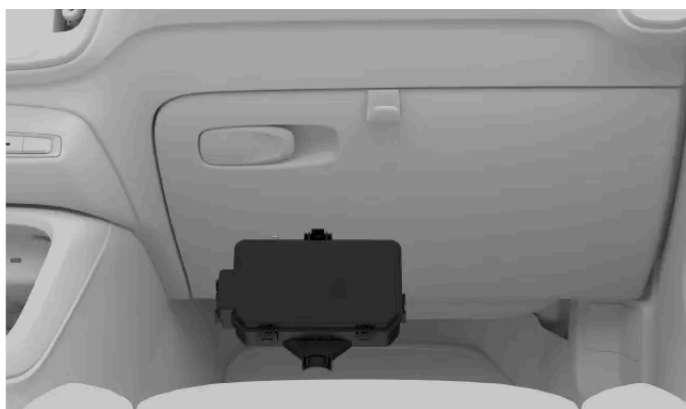
Emplacement du boîtier à fusibles
