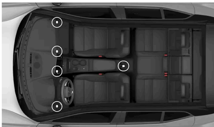
Emplacements des bouches d'air réglables
