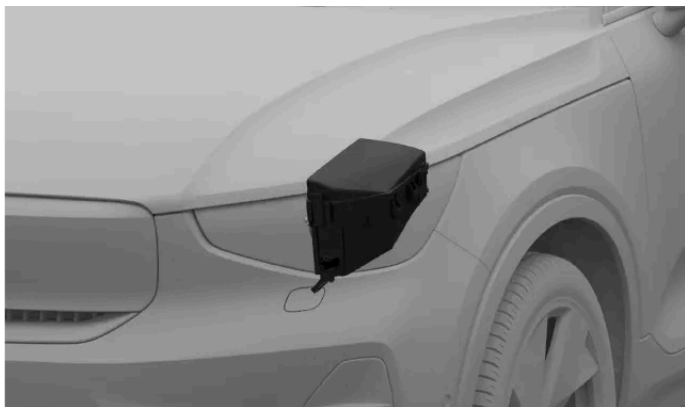
Emplacement du boîtier à fusibles
