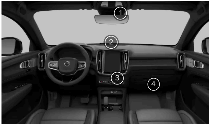
Capteurs de température de l'habitacle
