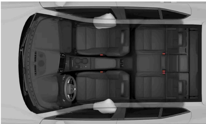
Coussins gonflables latéraux pour les occupants avant.
