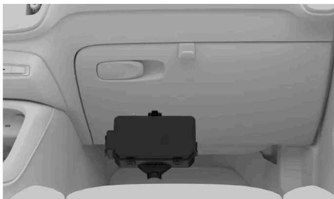
Emplacement du boîtier à fusibles
