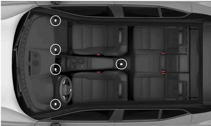
Emplacements des bouches d'air réglables
