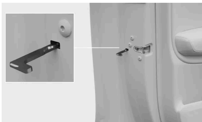
Emplacement de la clé pour la réinitialisation
