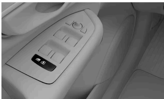
Emplacement du bouton de verrou de sécurité pour enfants dans le panneau de porte
