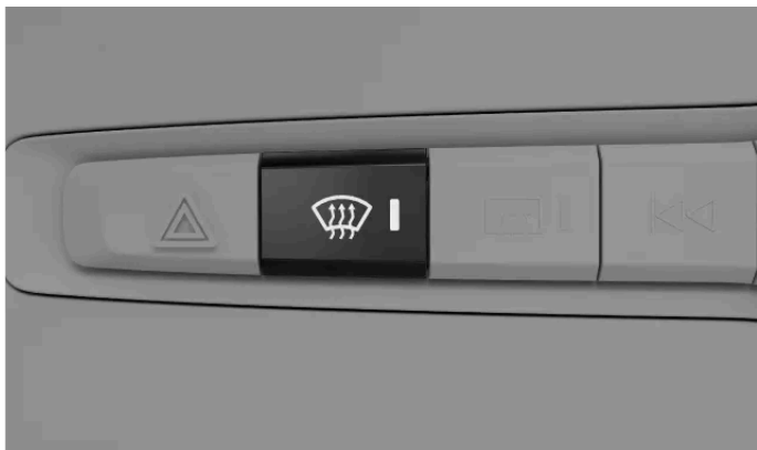
Bouton de dégivrage maximal sur le panneau de commande situé sous l'écran central
