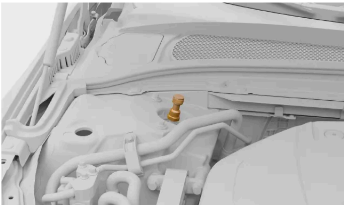
Les boutons de réglage de la suspension des roues avant sont situés sous le capot.
