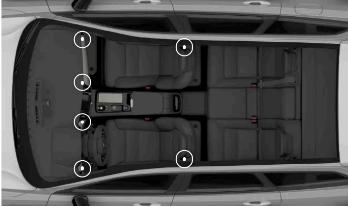
Emplacements des bouches d'air réglables
