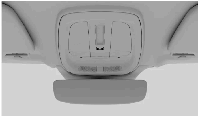
Bouton d'allumage simultané de toutes les lumières de l'habitacle situé sur la console au pavillon
