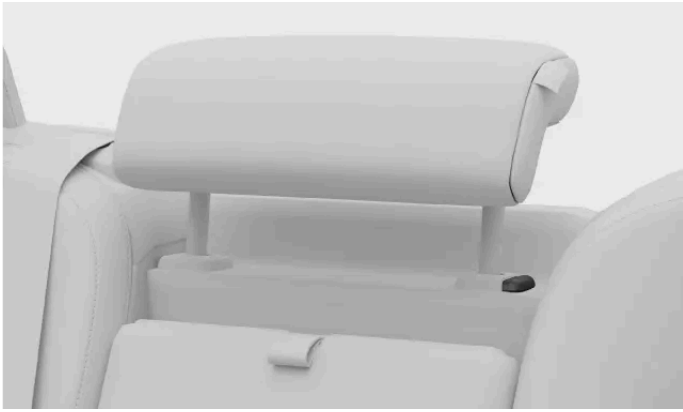
Bouton de verrouillage sur l'appuie-tête
